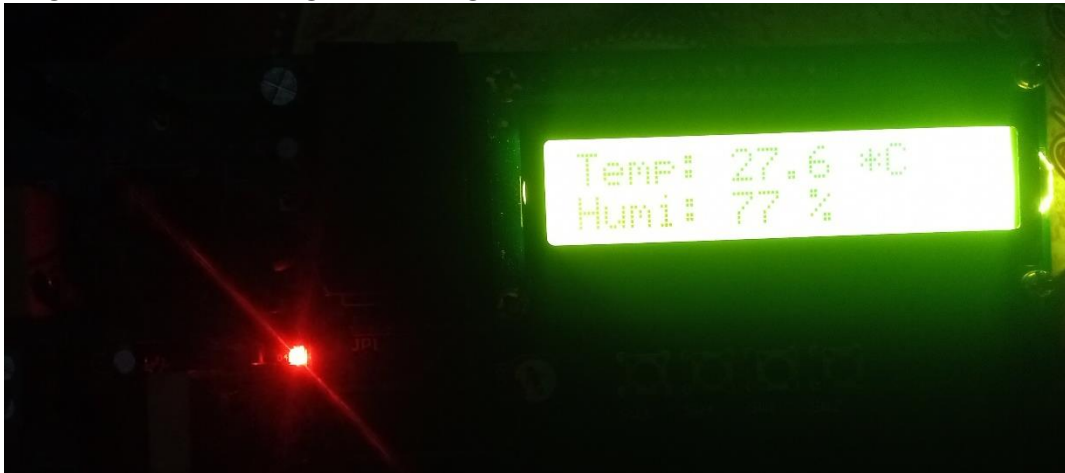
Hình 5: Mạch Master hiển thị nhiệt độ độ ẩm.
